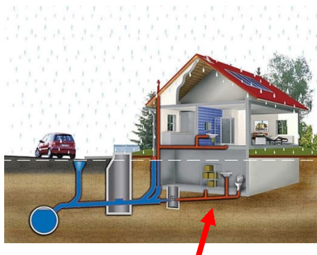
Abb. 18: Beispielbilder Rückstausicherung
